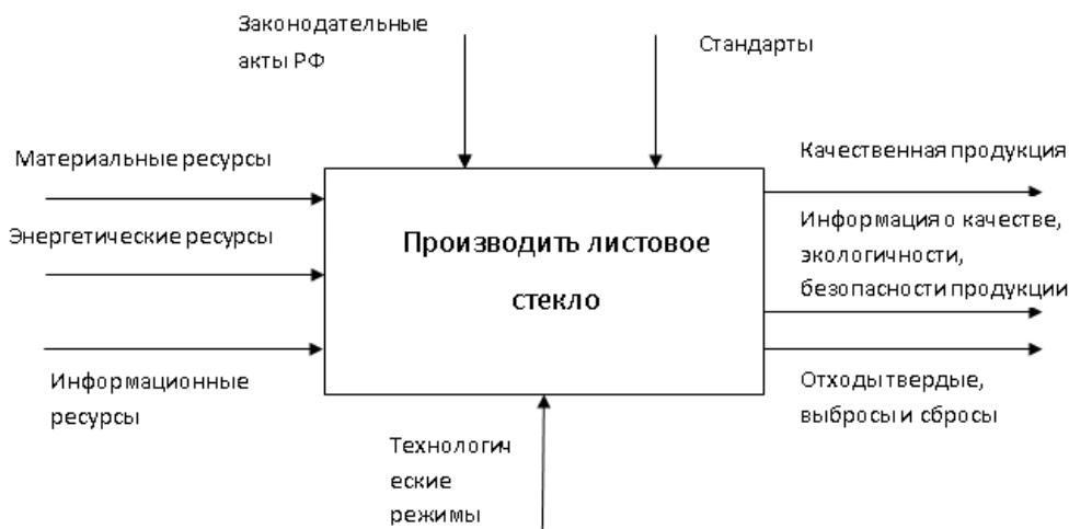
Рисунок 1 - Концептуальная модель технологического процесса производства листового стекла
